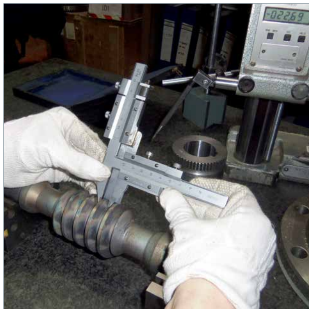
Размеры зубьев передачи проверяются нониусным штангензубомером.
