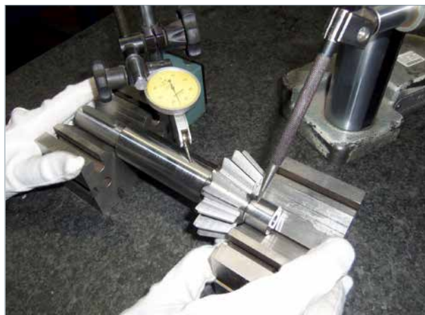
Проверка соосности при помощи индикатора с круговой шкалой.
