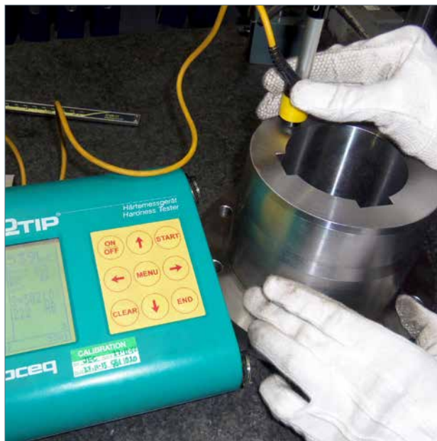
Проверка твердости ведущей муфты прибором Equotip.
