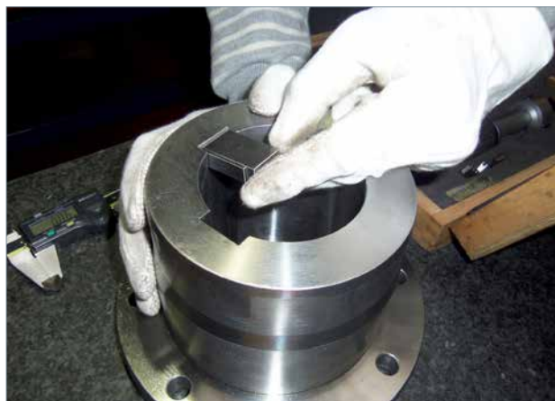
Проверка размеров отверстия и шпоночных пазов мерными плитками.
