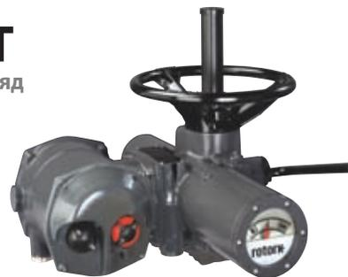
Модельный ряд A / AWT сочетает в себе качества защищенного электрического мотора и хорошо испытанного простого механического привода. Общая герметизация от окружающей среды согласно IP68 позволяет устанавливать интегральный пускатель мотора и электронное управление. Диапазон момента от 14 до 3,000 Нм (от 10 до 2,200 lbf-ft), прямой привод, до 250,000 Нм (185,000 lbf-ft) четвертьоборотный до 40,800 Нм (30,000 фнт-фт), многооборотный.
