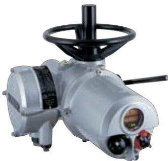
Модельный ряд приводов IQM совмещает технологии надежных электродвигателей, и прочной механики, разрабатывавшейся фирмой Rotork более 40 лет, с использованием новейших электронных методов, дополнивших модель IQ для получения регулирующих приводов ряда IQM. Диапазон крутящего момента от 12 до 550 Нм (от 9 до 400 lbf-ft). Осевое усилие зависит от линейного выхода IQML от 16 кН до 55 кН (от 3,500 до 5,600 lbf).
