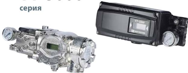
Серия YT-3000 для линейных и четвертьоборотных приводов обладает перенастраиваемым диапазоном хода и способностью вращения, автоматической настройкой и калибровкой и протоколом HART.
