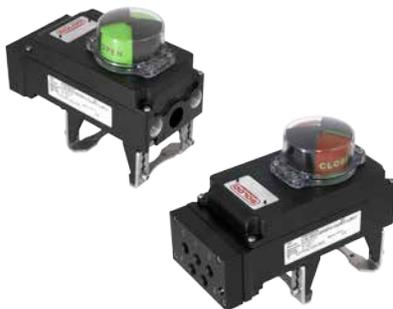
HW – компактный блок управления с конечными выключателями с визуальной и дистанционной электрической индикацией; встроенный соленоидный клапан(ы) для управления арматурой; встроенный монтажный комплект NAMUR.
