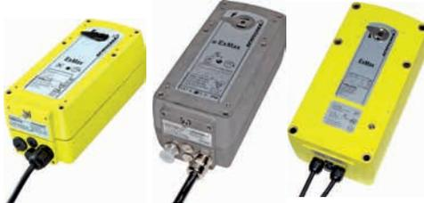
Электрические четвертьоборотные приводы ExMax с углом вращения 90° для заслонок и арматуры, предназначены для применения во взрывоопасных зонах с любыми газами, туманами, парами и пылью.
