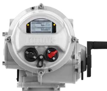
Привод IQTF предоставляет увеличенное вращение на выходе для неполнооборотной арматуры требующей более 90° вращения. Типовое применение: перепускные клапаны 180° и 270° и требующие двунаправленного вращения многоходовые манифольды 360°. Привод IQTF имеет низкую скорость на выходе для более высокой точности позиционирования и также может использоваться в малооборотных, многооборотных применениях, где требуется медленное управление. Дополнительные характеристики перечислены на стр. 7.
