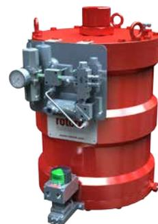
CQ – компактный четвертьоборотный привод концентрической конструкции на основании винтового механизма, преобразующего линейное перемещение поршня в четвертьоборотное вращение вала арматуры.
