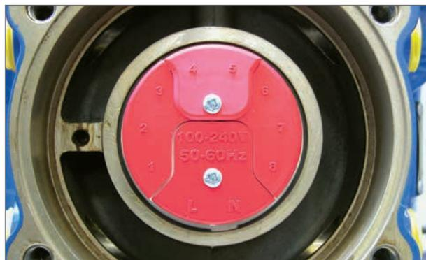
Клеммный блок - Рис. . 17.3
