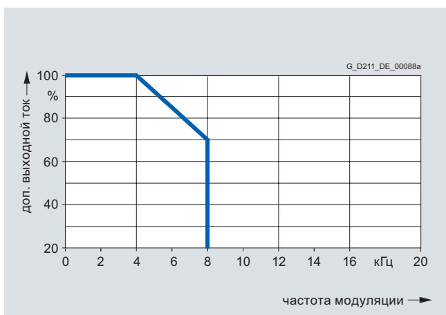
Типоразмеры FSF: выходной ток в зависимости от частоты модуляции
