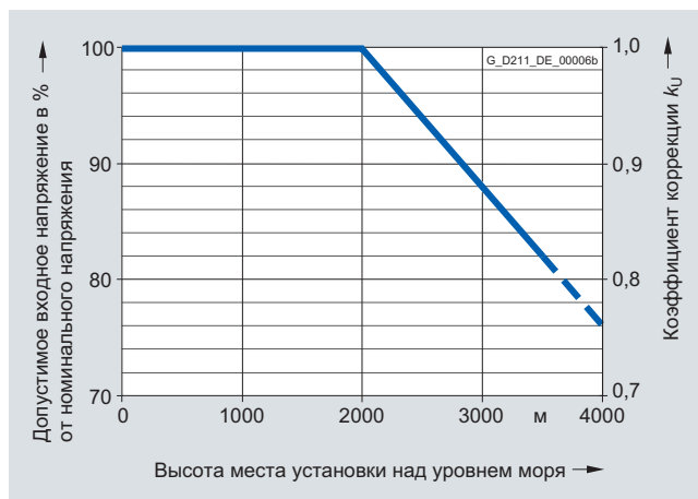
Снижение номинальных значений напряжения в зависимости от высоты места установки
