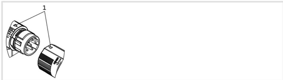
En reliant le connecteur côté câble et le connecteur moteur, veiller à ce que les points de repère se situent face à face (Pos. 1). C'est la condition minimum requise pour assurer un bon fonctionnement.
