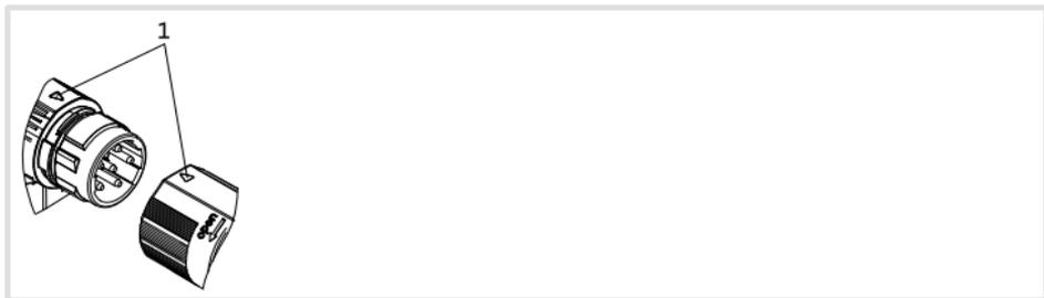
Beim Zusammenstecken des Kabel-Steckverbinders mit dem Motorstecker darauf achten, dass die Orientierungshilfe (Pos.1) gegenüberliegen. Nur so ist ein störungsfreier Betrieb gewährleistet.
