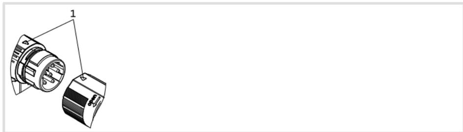
Nel congiungere il connettore ad innesto del cavo con il connettore motore, assicurarsi che le tacche di orientamento (pos.1) combacino. Solo così è possibile assicurare un funzionamento senza problemi.
