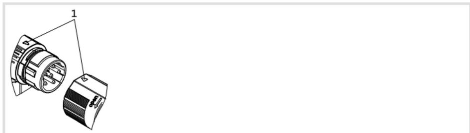
Al unir el conector enchufable del cable con el conector del motor observar que la ayuda para la orientación (pos. 1) se encuentre justo delante. Sólo así se puede asegurar un funcionamiento sin fallos.
