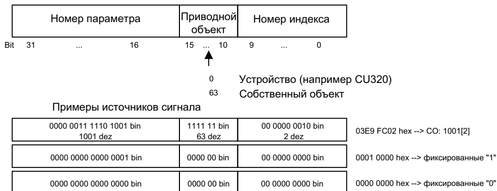
Изображение 6-6 Внутренняя кодировка параметров бинекторных/коннекторных выходов
