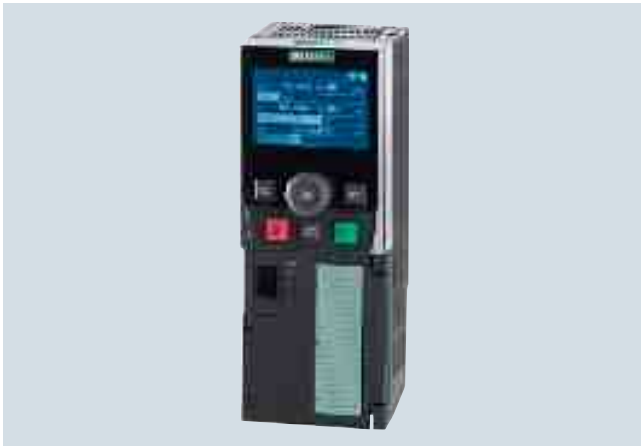
Управляющий модуль CU230P-2 со вставленной IOP
