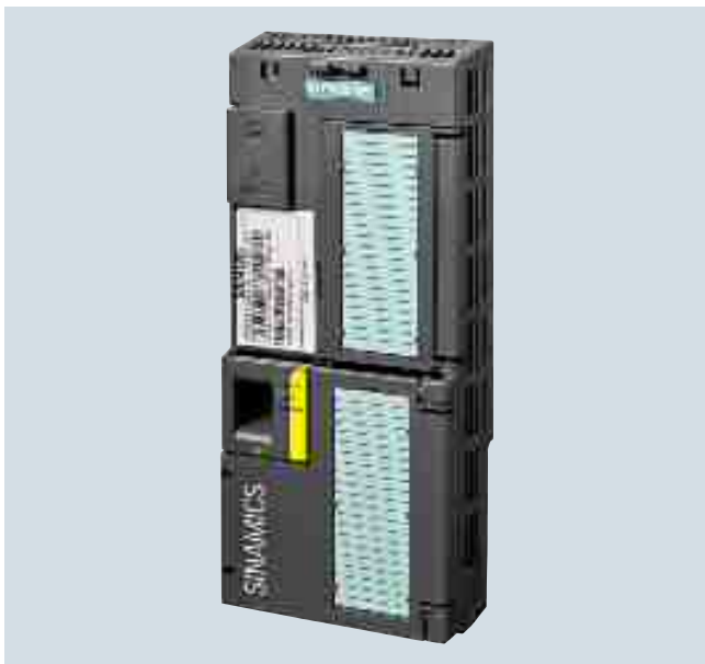
Управляющий модуль CU240E-2 DP-F
