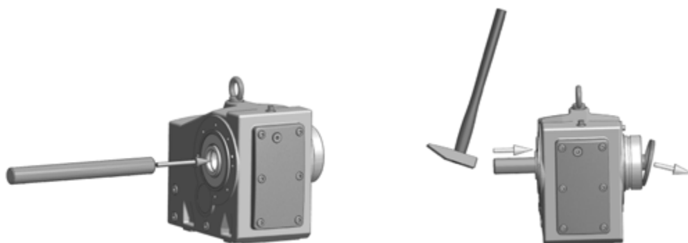
Рис. 6: Извлечение установленных на заводе заглушек
