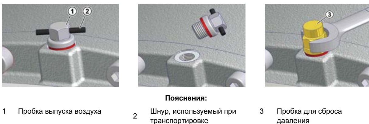
Рис. 3: Снятие пробки для выпуска воздуха и установка пробки для сброса давления
