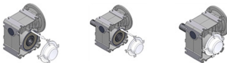
Рис. 14: Монтаж и демонтаж колпака
