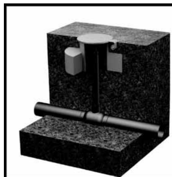
Подземный кран, установка под ковер
