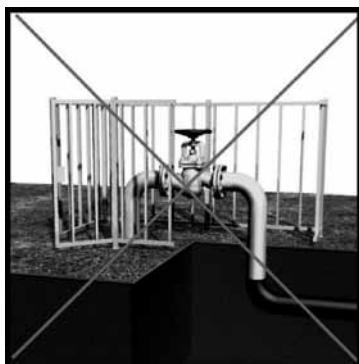
Наземная установка задвижки
