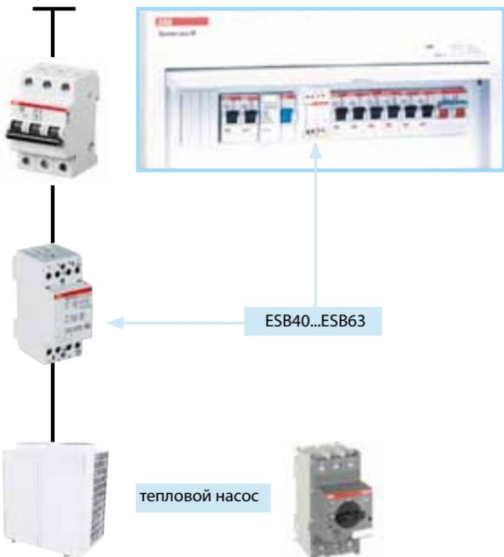
Тепловые насосы все чаще применяются в установках торговых и жилых зданий. Для управления этими мощными системами в основном применяют 4-полюсные контакторы ESB, при этом электродвигатели в таких установках отличаются от стандартных более высокими пусковыми токами.
