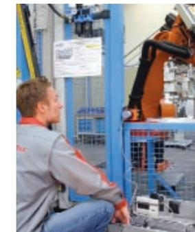
Для расчета безопасного расстояния решающую роль играет время до полного останова машины. Наши технические специалисты на месте выполняют необходимые измерения с помощью самых современных приборов, рассчитают безопасные расстояния для защитных устройств и задокументируют результаты измерений.
