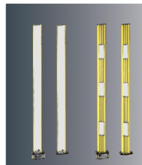
Зеркальные стойки UMC/MC -1000, -1300, -1600 и -1900 оснащены зеркалами для отклонения лучей по всей высоте стойки. Стойки UMC/MC-1002, -1302 и -1304 имеют по 2, 3 и 4 зеркала, соответственно, для отклонения отдельных световых лучей многолучевых защитных барьеров. Зеркальные стойки обеспечивают точность вертикальной и осевой центровки зеркал. Пружинные элементы, расположенные в опорах стоек (исполнение UMC), обеспечивают самост. возврат стойки в исходное положение после удара.
