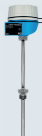
Термопары Широко распространенный тип контактных термометров, особенно актуален для измерения высоких температур: применяется в широком диапазоне: -40...+1700°C, опционально комплектуется коррозионно-стойкими и жаропрочными термогильзами
