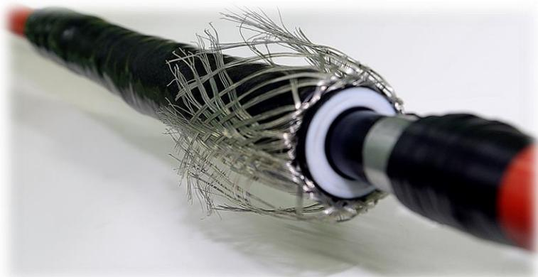
Компактный и короткий корпус со **всеми компонентами** (контролирующий напряжение, изоляционный, полупроводниковый, с металлической и внешней защитой) предварительно собранный **на одну съемную опору**, которая позволяет быстро и легко устанавливать соединительную муфту. **Использование спаянных или других устройств для соединения механической защиты не требуется.**
