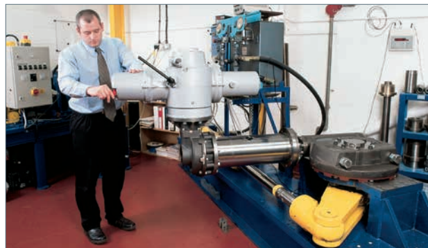
Испытания на долговечность опытного образца подводного редуктора.
