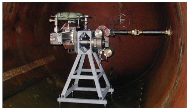
Гидростатические квалификационные испытания подводного редуктора.
