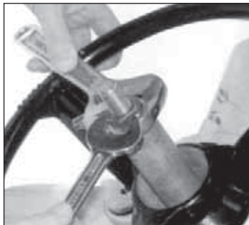
Рис. 5.6 Два гаечных ключа для нижнего стопора
