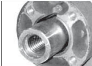
Рис. 4.11 Ведущая втулка типа Z3 в положении 3
