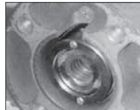
Рис. 4.8 Ведущая втулка типа А в положении 1
