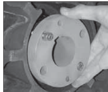
Рис. 4.14 Ведущая втулка В3/В4 по месту установки
