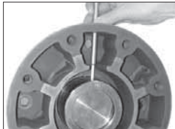
Рис. 4.5 Нахождение установочного винта
