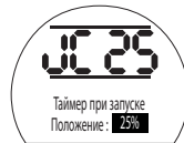
Таймер настроен на пусковой импульс, когда закрывающийся клапан достигнет 25% Открытия
