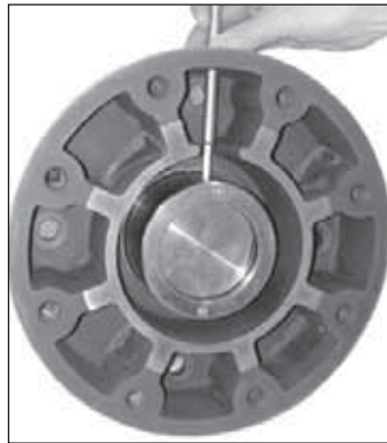
Рис. 4.12 Затягивание установочного винта фиксатора
