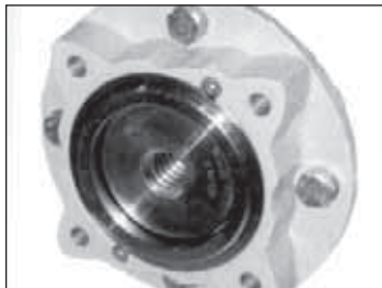
Рис. 4 Бронзовая ведущая втулка, установленная в воспринимающую осевую нагрузку основу
