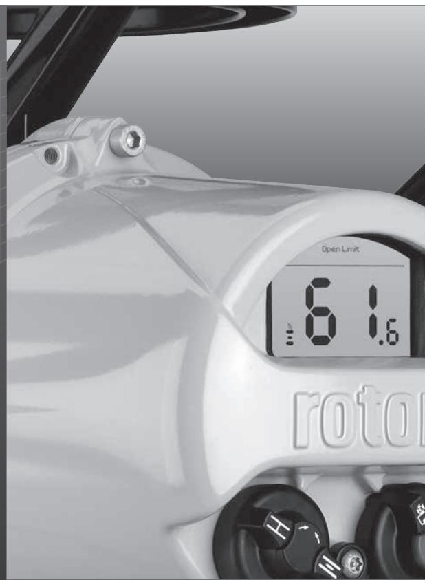
Проверенные приводы Роторк серии IQ теперь включают абсолютный датчик положения, большой информативный дисплей, расширенный журнал регистрации данных, состояние и управление активами, а также дополнительные варианты управления и индикации. Приводы серии IQ собраны в едином корпусе, настраиваются без вскрытия корпуса и предназначены для дистанционного и местного управления арматурой.
