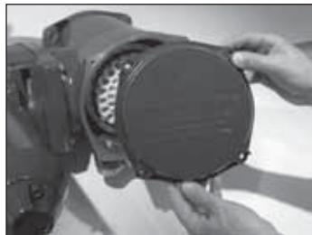
Рис. 7.1 Снятие крышки клеммной коробки – Syncropak
