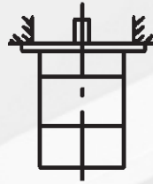
IM V3 (IM 3031) Wellenende nach oben Befestigungsflansch Form A Shaft upward Flange type A
