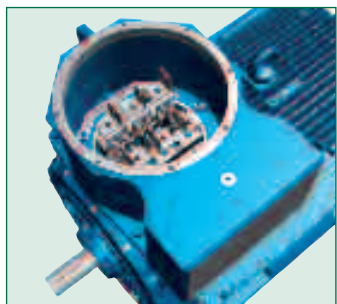
Рис. 10. Кабельные зажимы для двигателей типоразмеров 355-400
