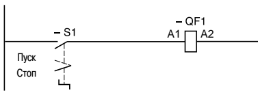
Двухпроводное управление при помощи двухпозиционного переключателя
