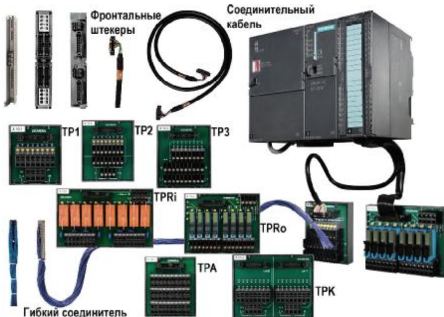
В зависимости от модификации терминальные блоки могут иметь контакты с винтовыми зажимами или пружинные контакты-защелки. Большинство терминальных блоков имеет две модификации: с или без встроенных светодиодов. Все терминальные блоки монтируются на стандартную 35мм профильную шину DIN. В соединителях SIMATIC TOP Connect могут использоваться терминальные блоки следующих типов.
