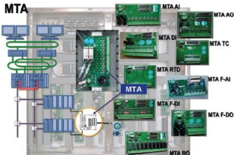
Подключение цепей питания и каналов ввода-вывода производится через съемные соединители. В устройствах МТА для ввода-вывода аналоговых сигналов предусмотрена возможность подключения ручного HART терминала к любому каналу.
