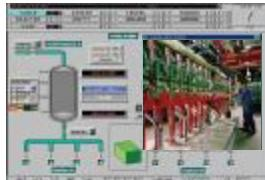
Рабочие станции системы SIMATIC PCS7 спроектированы с учетом специальных требований, предъявляемых к системам управления процессами. Базовым программным обеспечением рабочих станций является WinCC (Windows Control Center).
