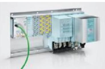
Модуль пускателя состоит из шинного соединителя и силового модуля. Шинный соединитель устанавливается непосредственно на широкую профильную шину, содержит сквозные участки внутренней шины станции, шин питания 1L+ и 2L+ и служит основой для установки силового модуля. Силовой модуль содержит внутреннюю электронику и обычный (DSe) или реверсивный (RSe) контактор. Электроника получает питание от шины 1L+, обмотка(и) контактора – от шины 2L+.
