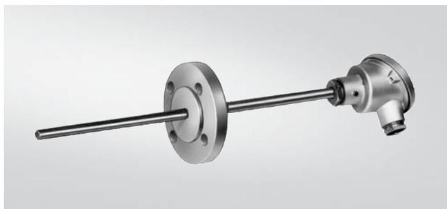
Фланцевый термометр сопротивления с соединительной головкой может монтироваться в резервуары и трубопроводы; он подходит для диапазона температур  $-50 \dots +600 \text{ }^\circ\text{C}$  и может поставляться также со встроенным измерительным преобразователем температуры.
