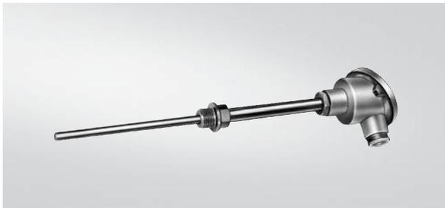
Ввинчивающийся термометр сопротивления низкого давления с соединительной головкой и консолью подходит для диапазона температур -50 ... +600 °C и может поставляться также со встроенным измерительным преобразователем температуры.
