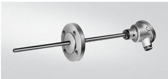
Фланцевый термометр сопротивления с соединительной головкой и меньшим временем перехода может монтироваться в резервуары и трубопроводы; он подходит для диапазона температур - 50 ... +600 °С. Чувствительный элемент поставляется также и со встроенным измерительным преобразователем температуры.
