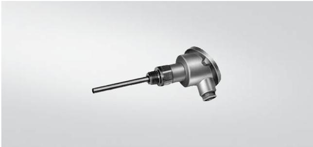
Ввинчивающийся термометр сопротивления низкого давления с соединительной головкой (без консоли) подходит для диапазона температур -50 ... +400 °C и может поставляться также со встроенным измерительным преобразователем температуры.
