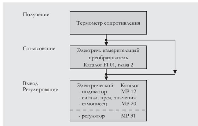
Комбинация приборов, с термометром сопротивления в качестве датчика
