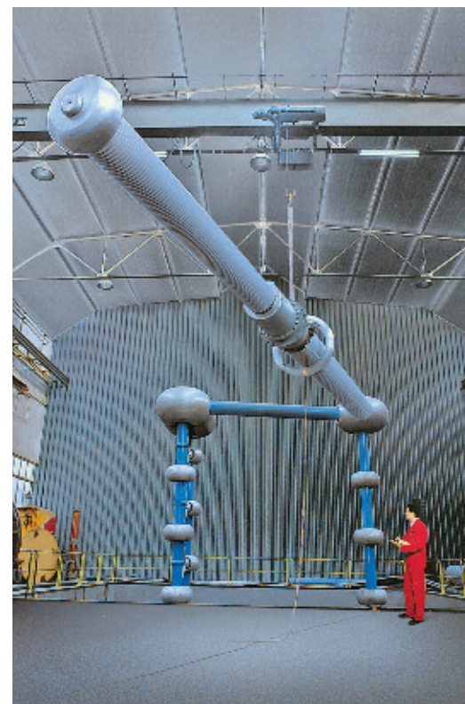
Рис. 69. Испытание настенного высоковольтного ввода постоянного тока
