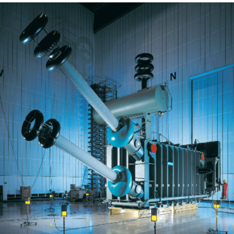
Рис. 64: Высоковольтные вводы постоянного тока на 500 кВ – Three Gorges, Китай
