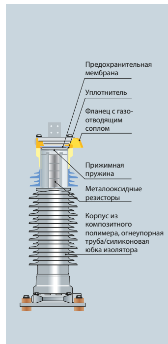
Рис. 32. ОПН в корпусе из полимерного материала с трубчатой конструкцией. Вид в разрезе
