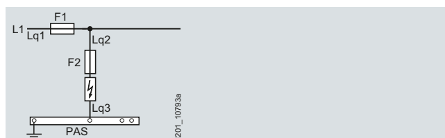
б) Защита ограничителей перенапряжений с использованием предохранителей
