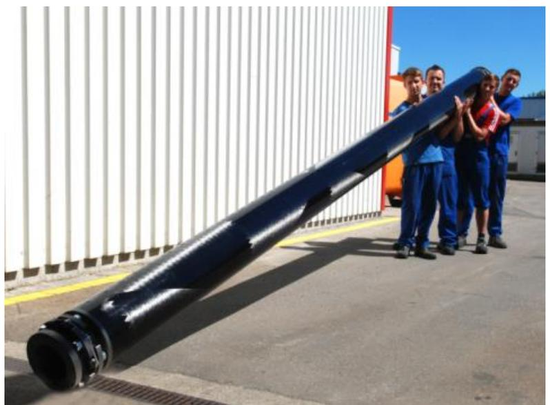
Отверстия во втулках таких муфт выполняются в собранном состоянии. Это позволяет достичь исключительной соосности (концентричности) двух отверстий. Это сводит к минимуму вибрации и нагрузки на подшипники. Благодаря балансировке муфты в собранном состоянии качество балансировки сохраняется даже после неоднократной сборки и разборки.
