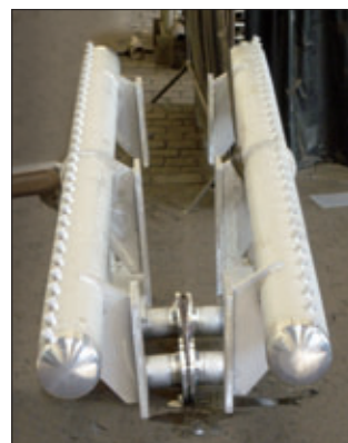
Оптимизированный распылительный коллектор разработанный и произведенный компанией Lechler
