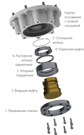
Рис. 5.1.4 Основание в сборе F25 и F30
