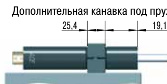
Дополнительная канавка под пружинное кольцо Перегородочное крепление для VC25...F с крепежным блоком KB... (доступен корпус 23,8 мм без резьбы)
