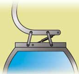
Раскачивание, амортизируемое гидравлическим демпфером
