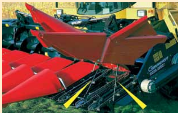
Промышленные газовые пружины поддерживают тяжелые крышки капотов
