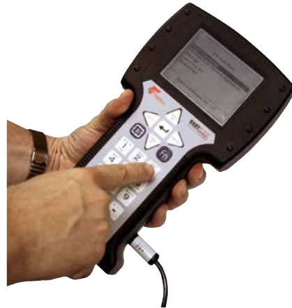
Рис. 1. Rosemount 375. CVA можно настроить с помощью устройства с Bluetooth®, например, КПК или ПК, в качестве альтернативы, можно использовать стандартный рабочий коммуникатор HART.
