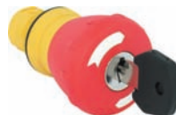
Аварийный останов 40 мм, без подсветки, разблокировка ключом
