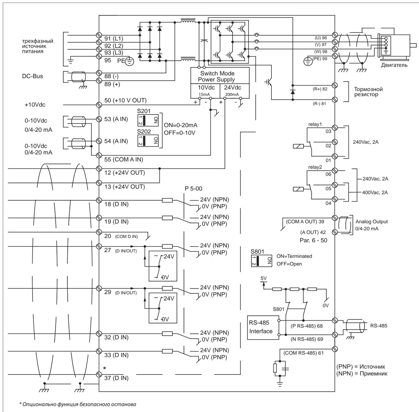
На схеме показан типичный вариант монтажа VLT® AQUA Drive. Напряжение питания подключается к клеммам 91 (L1), 92 (L2) и 93 (L3), а двигатель подключается к клеммам 96 (U), 97 (V) и 98 (W).
