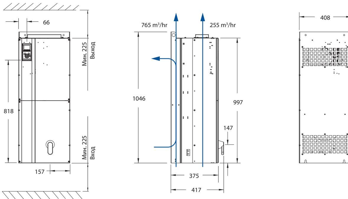
Корпуса D4 (Установка в шкаф)
