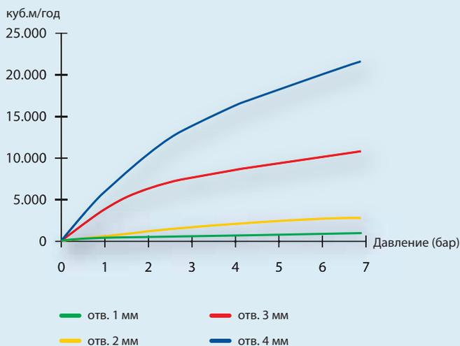
Уменьшение потерь воды путем снижения давления становится тем эффективнее, чем больше отверстие прорыва.
