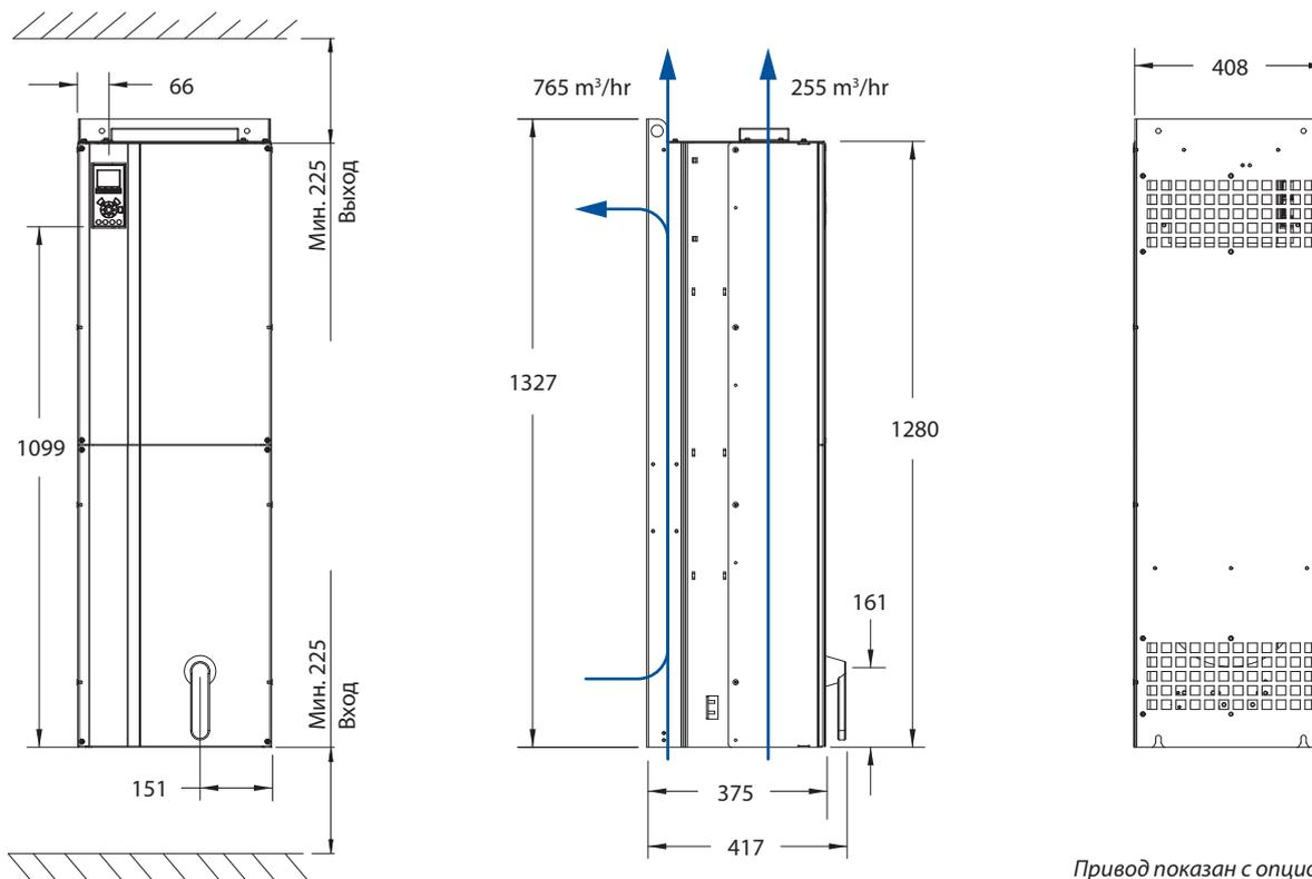
Привод показан с опциональным сетевым выключателем
