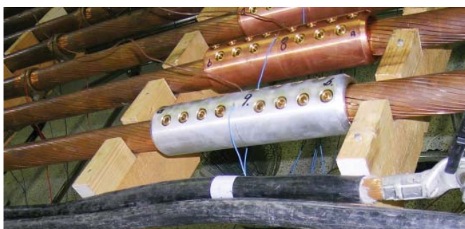
Испытание электрических соединений с применением надежной технологии болтового соединения.
