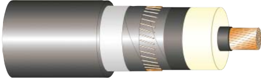
Кабель с медным проволочным экраном и поперечной герметизацией алюминиевой фольгой.
