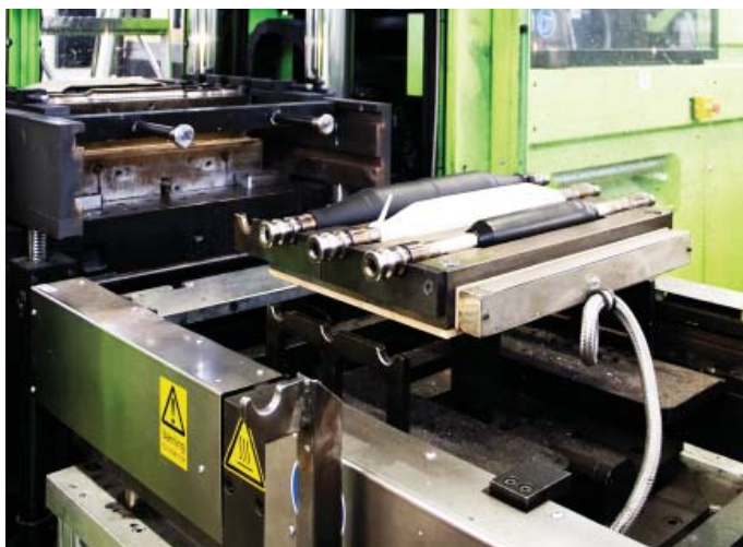
Три слоя муфты вулканизируются в один посредством уникального производственного процесса.
