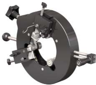
SH 50, SH 80, SH 130 Инструмент для удаления изоляции из сшитого полиэтилена и внешнего проводящего слоя. Этот инструмент поставляется в трех размерах в зависимости от диаметра изоляции кабеля из сшитого полиэтилена.
