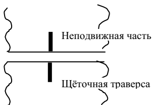
Рис. 5.6.4 а: Маркировка рабочего положения при направлении вращения в обе стороны или когда согласно стрелке вращение разрешено в одну сторону.
