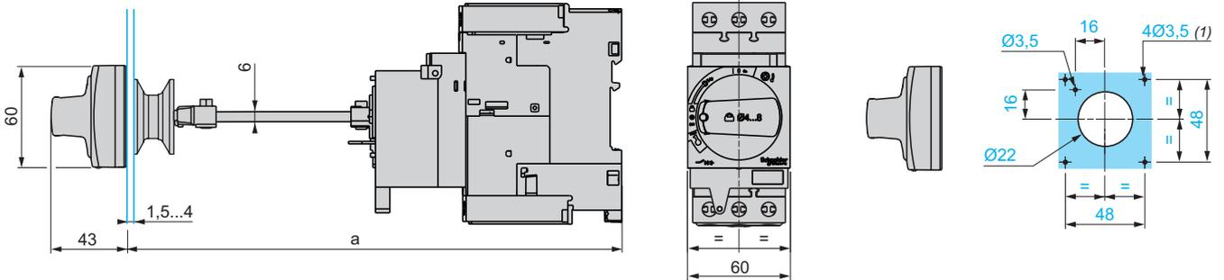
Монтаж выносной рукоятки управления GV APH03 для выключателя GV3
