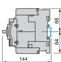
Монтаж на панели с помощью винтов M4
