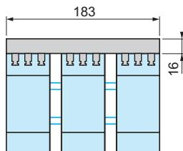
**Примечание.** Оставляйте промежуток 9 мм между двумя выключателями, либо установите в нем боковой блок вспомогательных контактов. Устанавливать аппараты вплотную можно, если их температура не превышает 40 °С.
