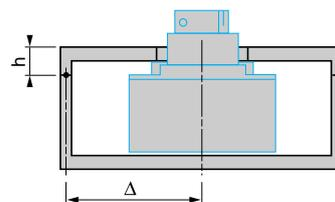
Отверстие в двери выполняется с минимальным расстоянием от центра автоматического выключателя до дверных петель  $\Delta \geq 100 + (h \times 5)$ .
