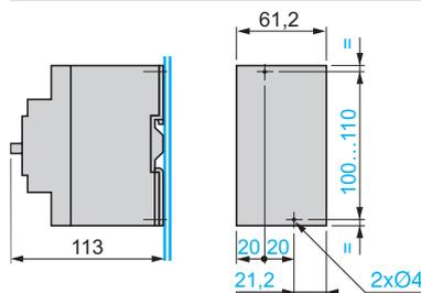
Монтаж на перфорированной панели AM1 PA
