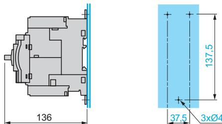
Монтаж на перфорированной панели AM1 PA
