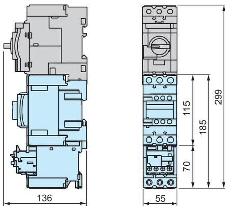
Монтаж в ряд с контактором TeSys LC1 D40A...D65A (Система S-образных шин GV3 S)
