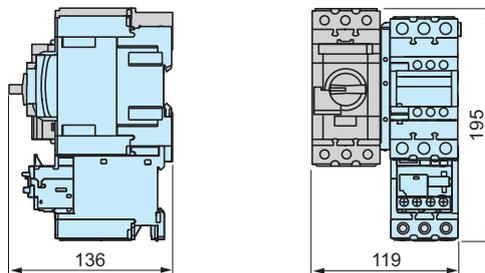
Монтаж на рейке AM1 DE200 или AM1 ED201
