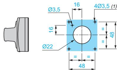
Монтаж выносной рукоятки управления GV APH02 для выключателя GV2 L
