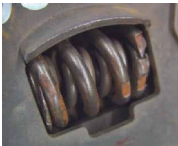
Пример износа демпфера и поломки пружины
